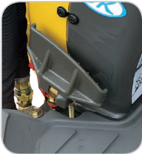
Składane pedały (sterowanie PTO i obrót wysięgnika)
