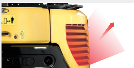
Chłodzenie powietrza silnikowego i skierowanie go ku górze (ochrona osób i okolicznych roślin)
